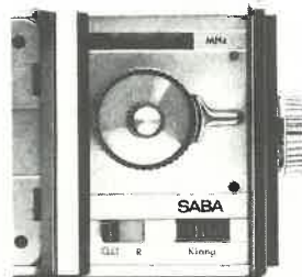
Oben: Senderskala (Mittelwelle). Große Scheibe: Lautstärke. Kleiner Knopf: Senderwahl. Taste (daneben): Spürwähler. Links: Schalter Band/Radio. Rechts daneben: Klangfarbe.
