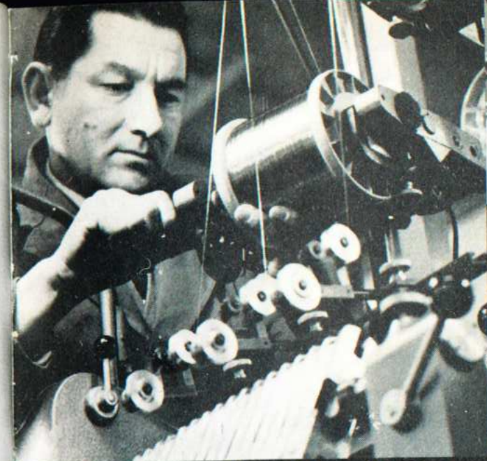
Eine von 640 Firmen der Bundesrepublik, die auf der Leipziger Messe 1963 ausstellten, ist die Firma Frieske & Hoepfner aus Erlangen. Sie zeigte eine automatische Träufelpulverwickelmaschine (FH 88 T) mit vier- bis zehnfachem Programmzählwerk. Insgesamt waren 9 000 Aussteller aus 63 Ländern in Leipzig.
