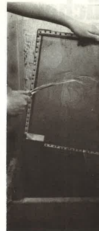
Nach dem Drucken: Das Sieb muß sofort gereinigt werden, will man es mehr als einmal benutzen. Das Sieb wird der Reihe nach a) mit Terpentin von Farbe, b) mit Seifenpulver von Terpentin gesäubert. Danach Kaliumpermanganat auf das Sieb geben, gut verreiben, mit Wasser abspülen: Die Schicht auf der Gaze wird bräunlich und damit sichtbar. Jetzt Kaliummetabisulfid aufstreuen, verreiben, mit Wasser wieder abspülen. Ist die Gelatineschicht nach dieser ersten Behandlung noch nicht restlos entfernt, muß der Vorgang wiederholt werden.
