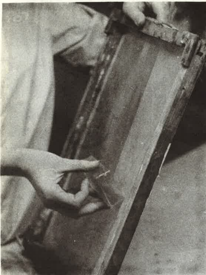
Bild 1: Mit der lichtempfindlichen Gelatine wird das saubere und trockene Drucksieb „beschichtet“: am besten die Gelatine in einen rechteckigen Plastikkasten geben und — damit, leicht gekantet, von unten nach oben über die Gaze ziehen. Die Gelatine muß gleichmäßig und ohne „Tropfnasen“ aufgetragen sein. Das beschichtete Sieb gut trocknen lassen (jedoch nicht an den Ofen stellen).
