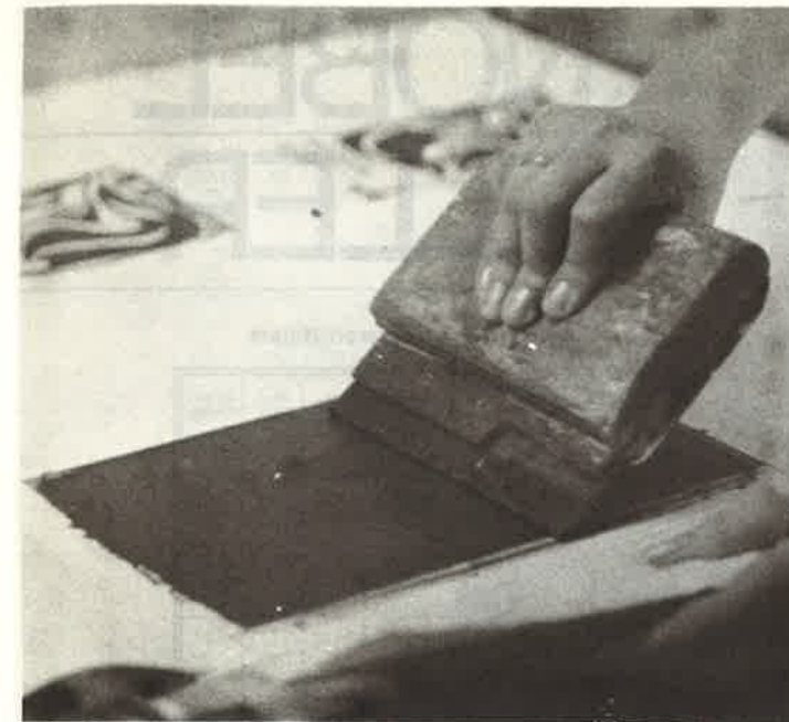
Bild 4: Man gibt nun eine Portion Farbe in das Sieb und legt es auf den zu bedruckenden Stapel Papier. Mit dem Gummirakel wird nun die Farbe mit gleichmäßiger Bewegung und mittlerem Druck über die zu druckenden Stellen gezogen.
