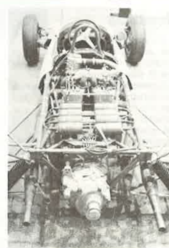
Lotus-Mitter-DKW Dieser Formel II-Wagen ist als Einzel exemplar von Gerhard Mitter (Böblingen) konstruiert worden. 4-Zylinder Drehschieber-DKW-Motor, 130 PS, 1000 ccm.
