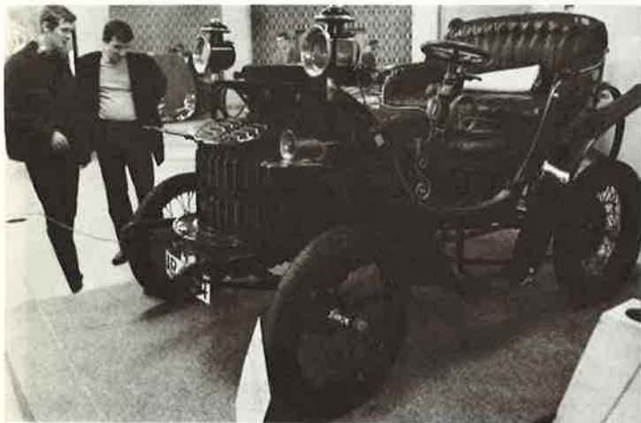
Oldtimer „Maurer-Unlon“ Viertakter, 1 Zylinder, Baujahr 1900, Reibradgetriebe, Kraftübertragung durch Kette. Höchstgeschwindigkeit 40 km/Std.
