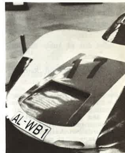
Porsche Carrera 6 6 Zylinder, 2000 ccm Hubraum, 210 PS, Spitze 270 km/Std.
