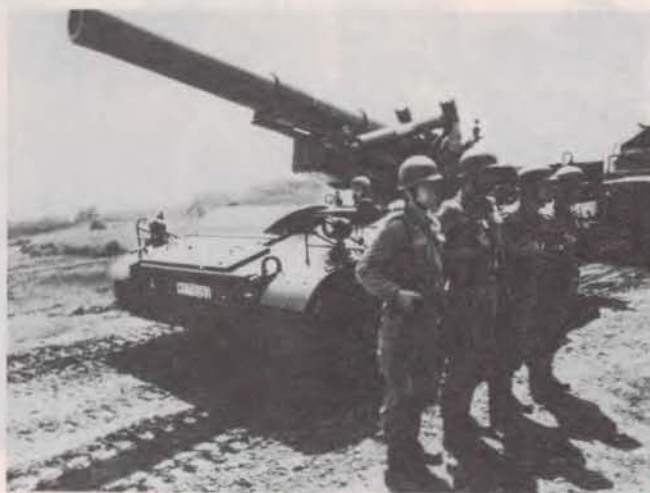
Selbstfahrende 203-mm-Haubitze, mit der gleichermaßen atomare, chemische und konventionelle Granaten verschossen werden können.
